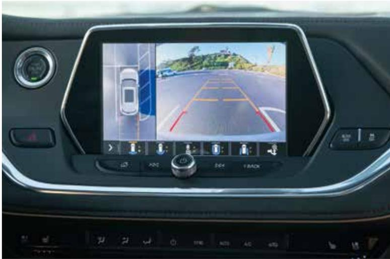
**ASISTENTE DE ESTACIONAMIENTO.** Gracias a los diferentes modos de visualización que se generan con las 4 cámaras que rodean el vehículo, se facilitan las maniobras de estacionamiento.
